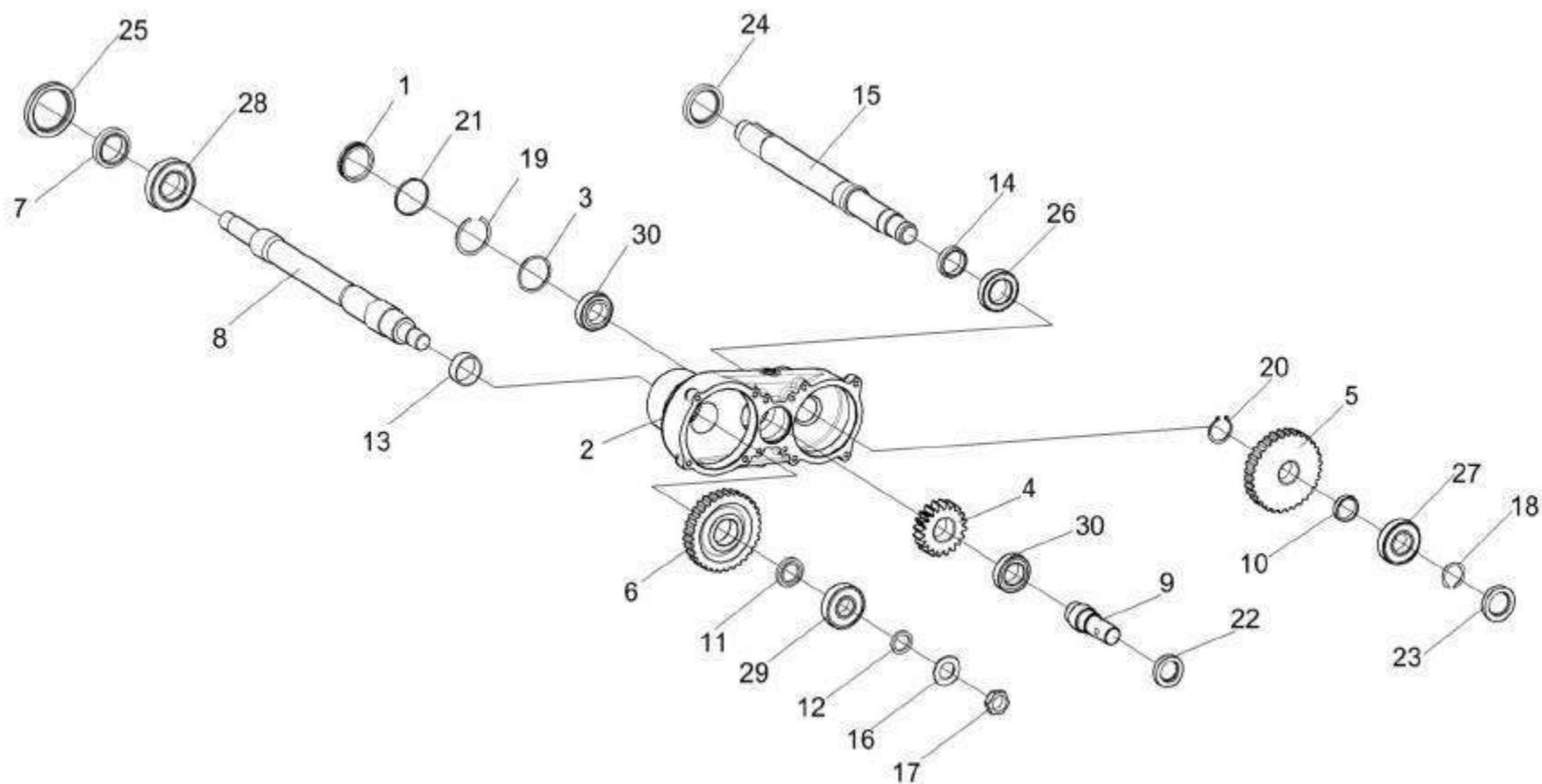
Рисунок 20 –РедукторцилиндрическийподпрессовывающихвалцовПКК 0118000Б-01 (лист 2)
