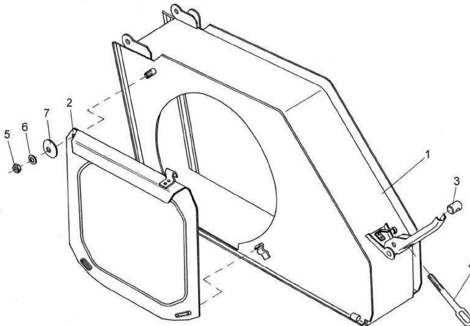
Рисунок 6 –КожухверхнийизмельчителяПКК 0103000А
