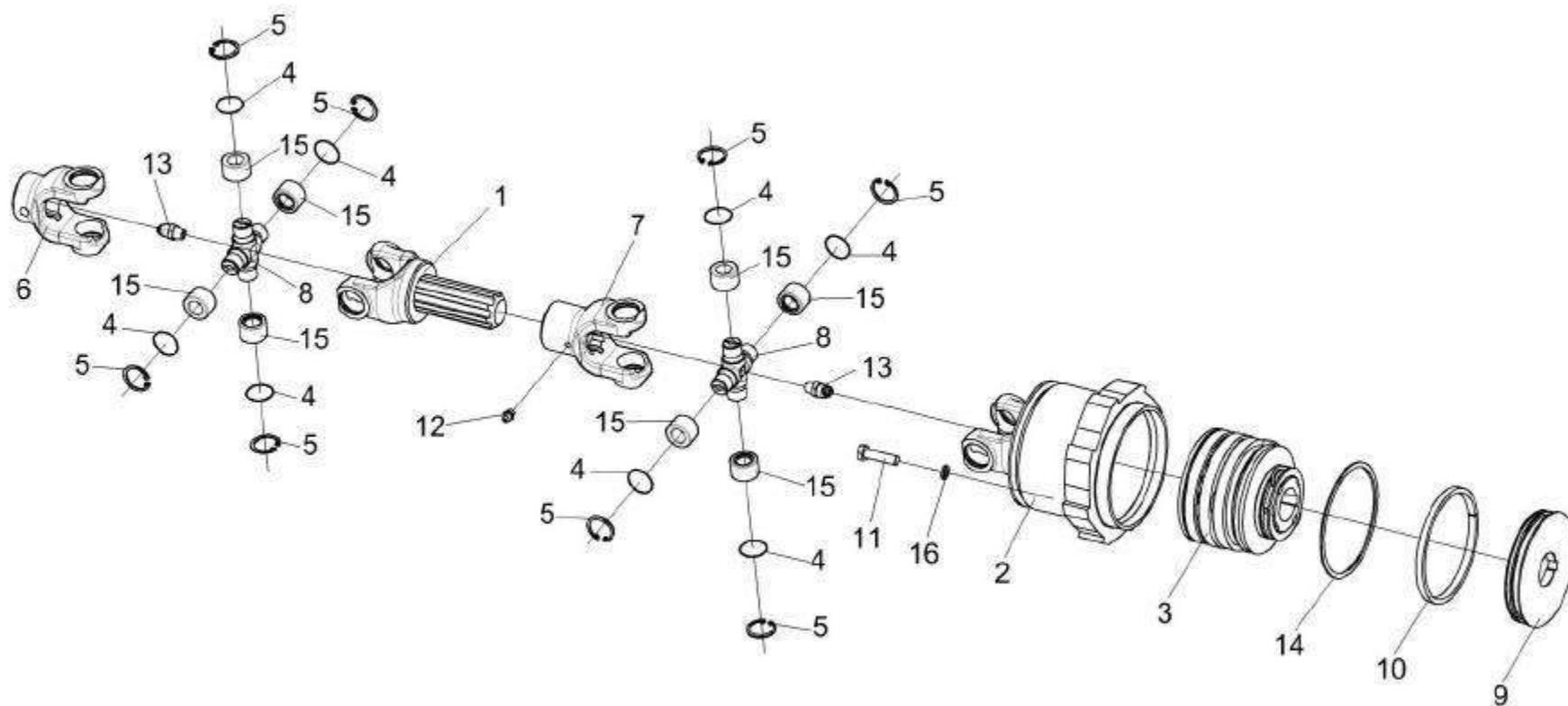
Рисунок 32 –Валкарданный телескопический с муфтой ПКК 0145000
