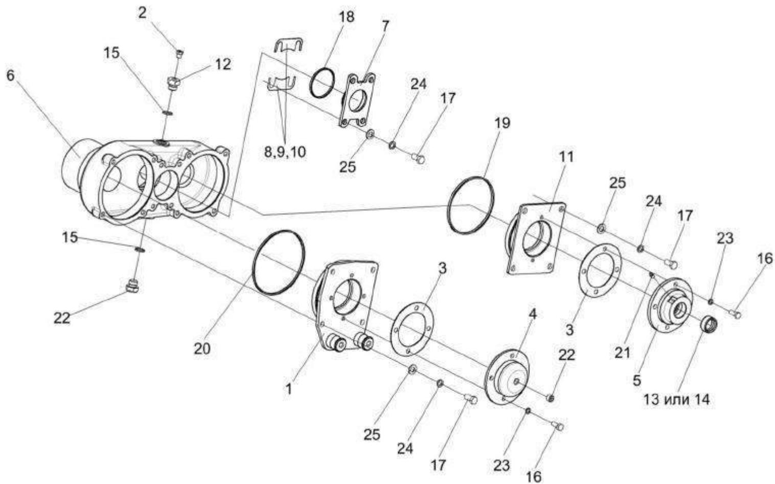
Рисунок 19 –РедукторцилиндрическийподпрессовывающихвалцевГКК 0118000Б-01 (лист 1)
