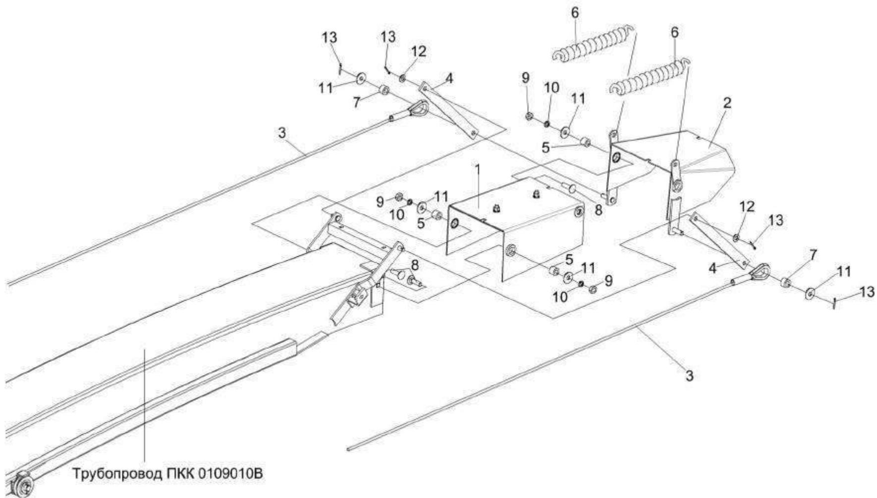
Рисунок 40 –СилосопроводПКК 0109000В (установкакозырьков)
