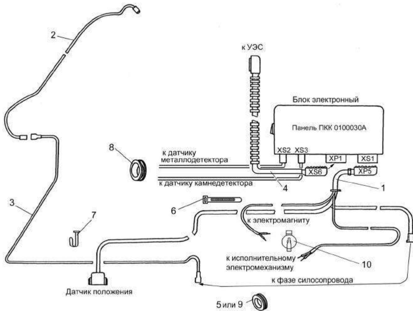
Рисунок 50 – Электрооборудование измельчителя ПКК 0100000А
