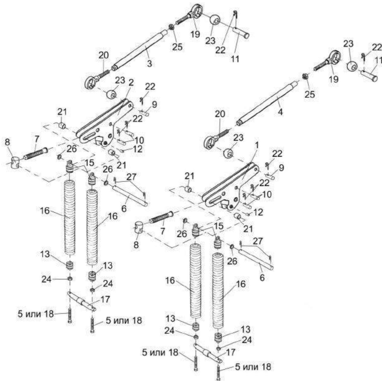
Рисунок 11 –Механизмы продольного копирования ПКК 0455000 и ПКК 0455000-01
