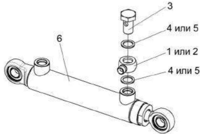
Рисунок 48 –ГидроцилиндрПКК 0113210
