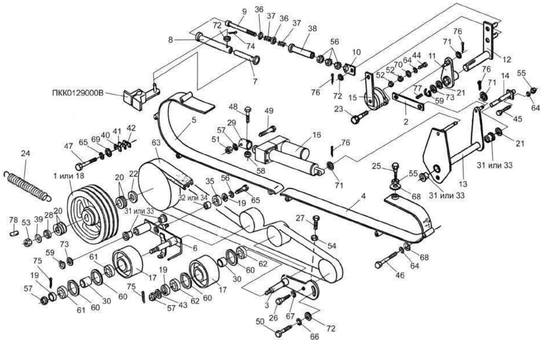
Рисунок 34 – Шкивы, ограждения привода ротора измельчителя
